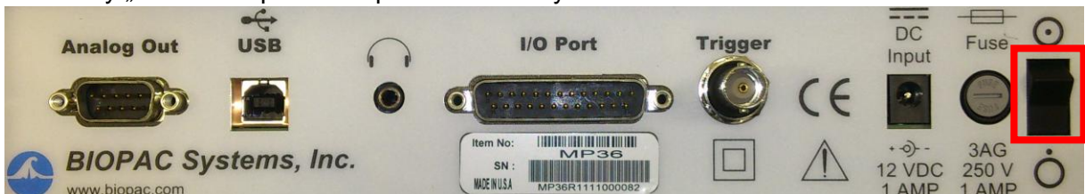
Rys. 2. Tylny panel MP36. Włącznik oznaczono czerwoną obwódką.
