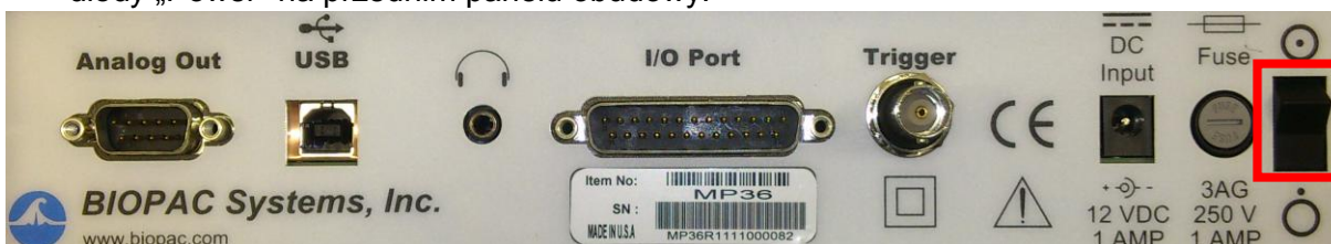
Rys. 2. Tylny panel MP36. Włącznik oznaczono czerwoną obwódką.
