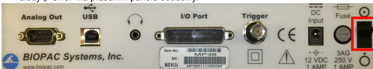
Rys. 2. Tylny panel MP36. Włącznik oznaczono czerwoną obwódką.
