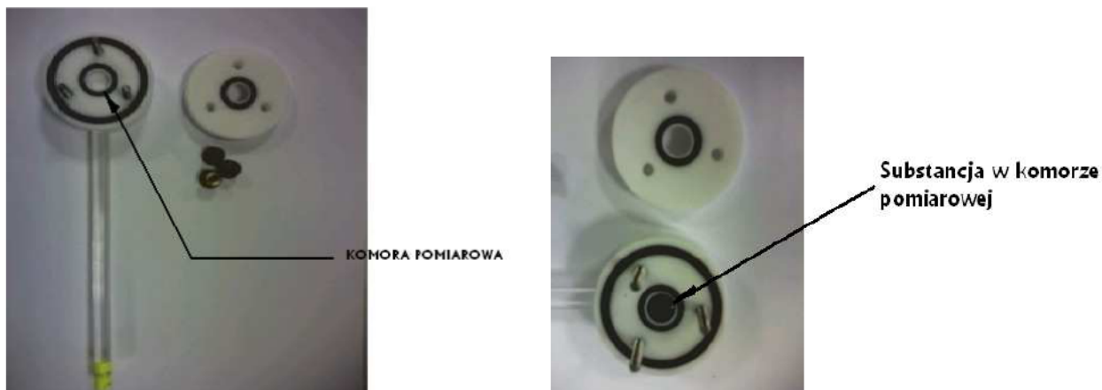
Rys. 1. Po lewej. Widok komory pomiarowej. Po prawej: Komora pomiarowa napełniona roztworem.
