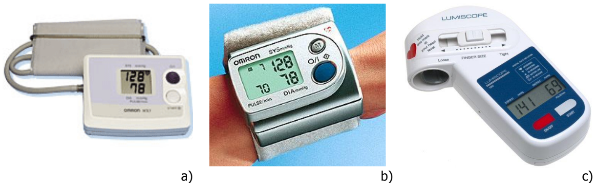
Rys. 6.6. Rodzaje mierników ciśnienia krwi, których mankiet okładujący umieszcza się: a) na ramieniu, b) na nadgarstku, c) na kciuku
